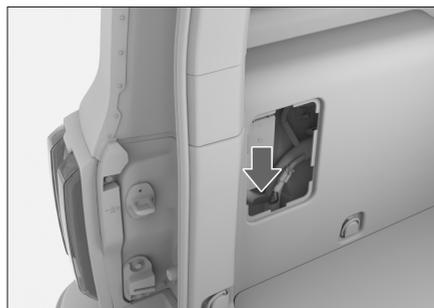
O ponto de corte de emergência está localizado na guarnição esquerda do porta-malas e pode ser visto ao abrir a tampa do porta-malas.
