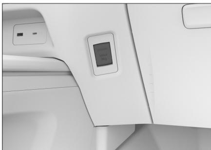
Para usar, pressione a extremidade superior do gancho e solte-o. O gancho se abrirá suavemente e virará para baixo.
