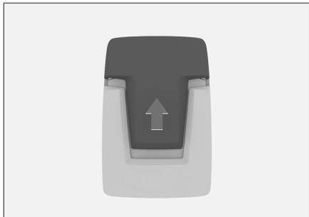
2. Empurre a chave mecânica para fora e remova-a.
