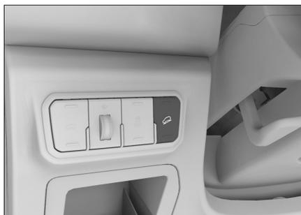
Com a ignição LIGADA, o HDC pode ser ativado ou desativado pressionando o interruptor.
