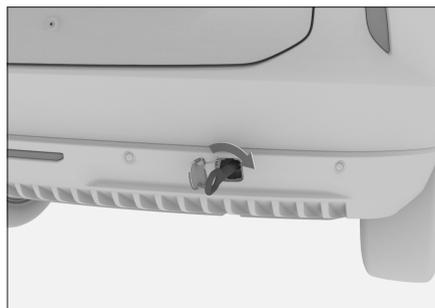
3. Instale o cabo de reboque no gancho, tomando cuidado para não danificar a carroceria do veículo.
