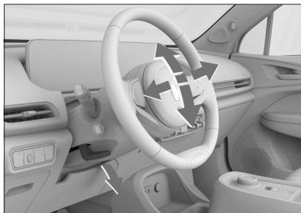
1. Solte a alavanca de ajuste sob o volante.
