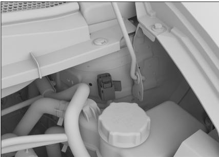
O interruptor de segurança da bateria de alta tensão está localizado no compartimento do motor, próximo à barra de suporte da carroçaria, e pode ser visto ao abrir o capô do motor e é utilizado para desligar ou ligar a fonte de alimentação do sistema de alta tensão.
