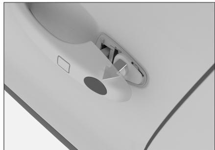
2. Insira a chave mecânica no orifício da trava da porta e gire a chave para travar ou destravar a porta.
